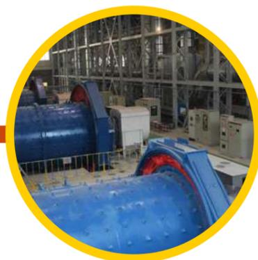
Трехстадийное дробление породы с последующим двухступенчатым измельчением рудных фракций в замкнутом цикле.
