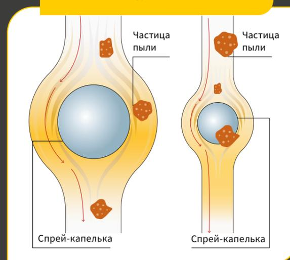
Система пылеподавления уменьшает количество вентиляторов, пылесборников и вентиляционных каналов и позволяет экономить от 30 до 50 % инвестиций по сравнению с обычными системами пылеудаления.
